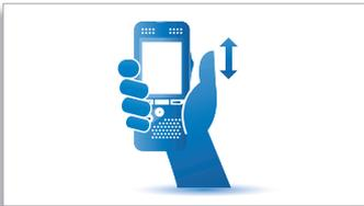
Der schnell reagierende und ergonomische Schiebeschalter wurde für die einhändige Bedienung sämtlicher Aufnahme- und Wiedergabefunktionen entwickelt und ermöglicht eine schnelle Dateibearbeitung (Einfügen, Überschreiben, Anhängen). Er funktioniert über ein Lichtsensor-Signal und ist dadurch verschleißfrei und langlebig.
